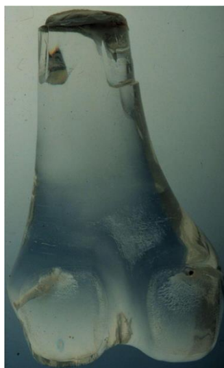
Рисунок 1.4. Акриловый эндопротез дистального отдела бедренной кости [122]
