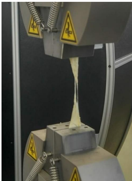
Рис. 7. Разрыв образца в области образовавшегося сужения после приложения максимальной нагрузки
