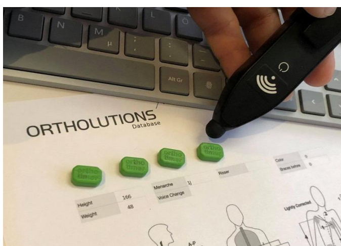
Рис.2.13. Температурные датчики «Orthotimer» со считывающим устройством
