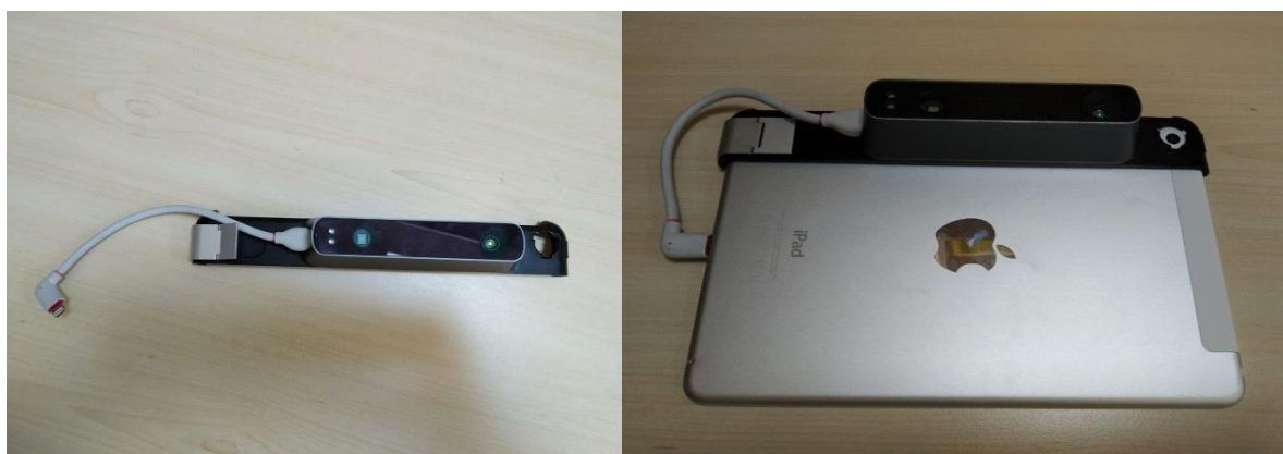
Рис 2.9. 3D сканер «Structure Sensor» в виде портативной насадки (А), соединенный с планшетом на базе Apple OIS (Б).
