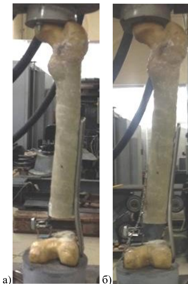
Рис. 2.2. Установка моделей переломов в испытательной машине: а) первая серия с латеральной фиксацией; б) вторая серия с двухсторонней (латеральной и медиальной) фиксацией.
