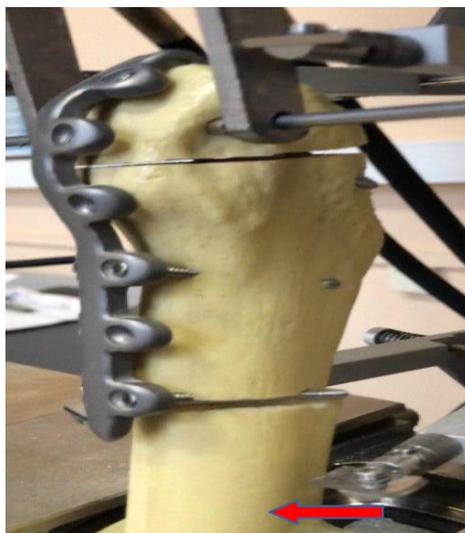
Рис. 1. Муляж пластиковой бедренной кости с имитацией перипротезного перелома и фиксацией фрагмента большого вертела фигурной вильчатой пластиной второго поколения после статического испытания на разрывной машине.
