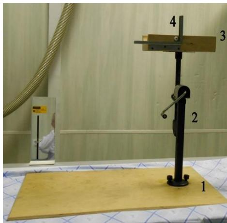
Рисунок 2.2 – Устройство для функциональной рентгенографии коленного сустава с целью объективизации нестабильности коленного сустава и определения ее степени: 1 – основание размерами 100x80 см; 2 – раздвижное устройство, 3 – ложемент для голени; 4 – кассетодержатель.
