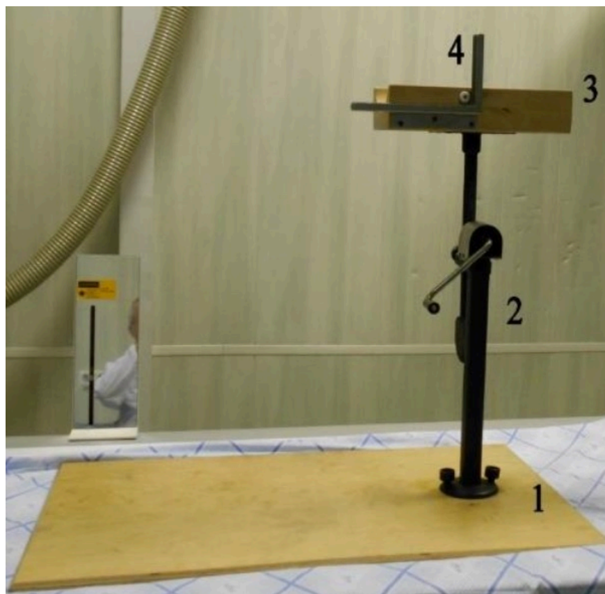
Рисунок 2.12 – Устройство для сравнительной функциональной рентгенографии коленного сустава – объективизации и определения степени нестабильности коленного сустава: 1 – основание размерами 100х80 см; 2 – раздвижное устройство, 3 – подставка для голени; 4 – фиксатор рентгеновской кассеты
