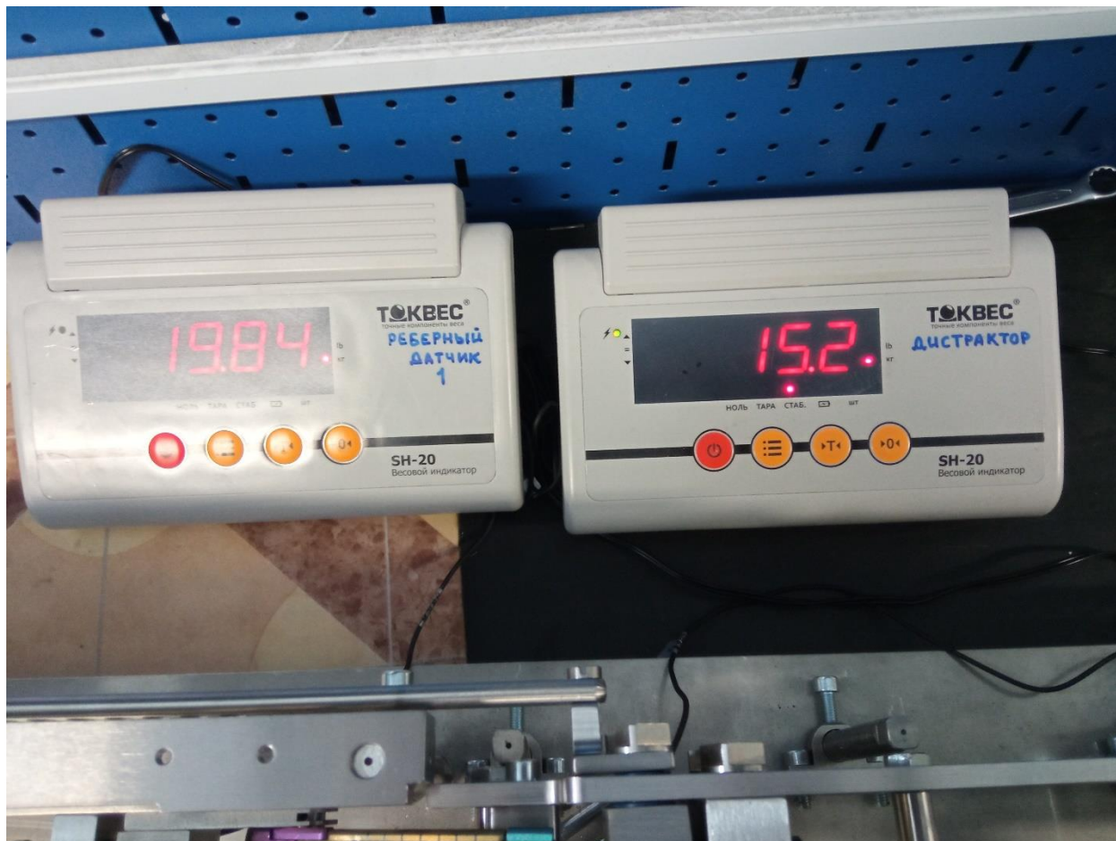
Рис. 3.8 Этап фиксации показателей при выполнении дистракции реберной части дистрактором: монитор тензодатчика реберной секции испытательного стенда, усилие составляет 19,84 кг; монитор тензодатчиков реберного дистрактора, усилие составляет 15,2 кг
