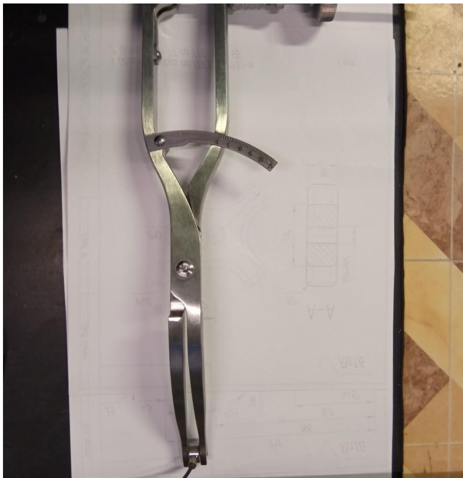
Рис. 3.13. Калибровка контрактора, оснащенного динамометрическим блоком, при помощи тензодатчика
