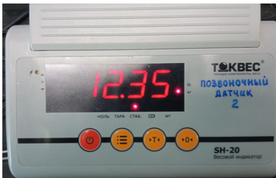
Рис. 3.3. Монитор тензодатчика позвоночной секции испытательного стенда, усилие на этапе завершения контракции составляет 12,35 кг
