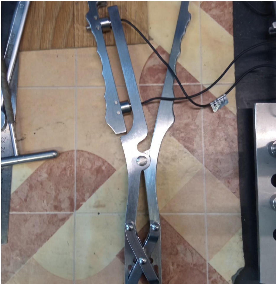
Рис. 3.6. Дистрактор стандартный, оснащенный тензодатчиками
