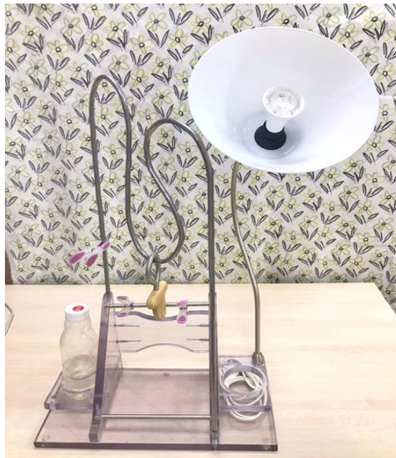
Рис. 1. Учебно-тренировочный стенд для оценки результатов функционального протезирования и наработки навыков пользования протезом
