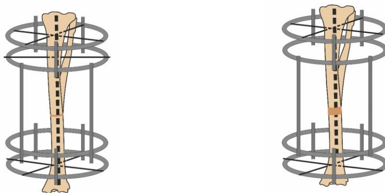
Рис. 1. Схема экспериментальной модели: а – после выполнения комбинированного остеосинтеза, б – в конце дистракции после удаления спицы из парафрактурной опоры.
