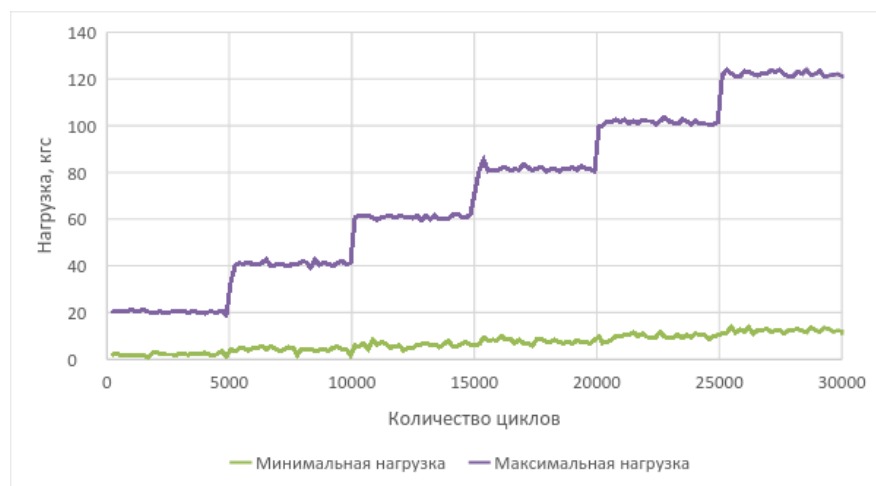
Рисунок 2.3. График изменений минимальных и максимальных нагрузок в шести последовательных циклах нагружения
