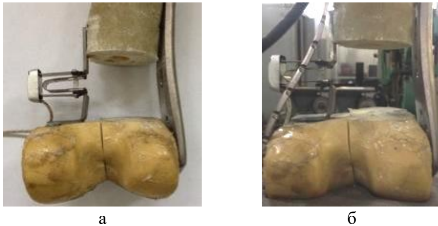
Рисунок 2.1. Модели перелома бедренной кости с установленными датчиками перемещений: а – первая серия с латеральной фиксацией; б – вторая серия с двусторонней фиксацией
