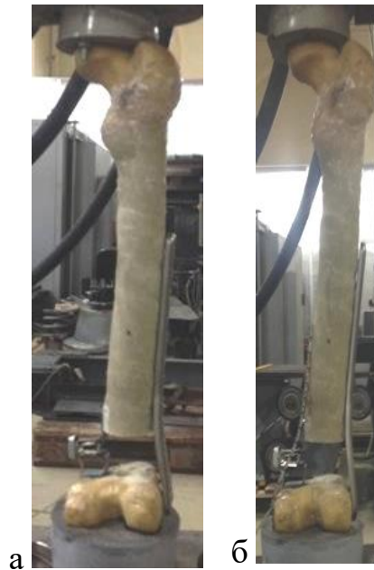
Рисунок 2.2. Установка моделей переломов в испытательной машине: а – первая серия с латеральной фиксацией; б – вторая серия с двухсторонней (латеральной и медиальной) фиксацией
