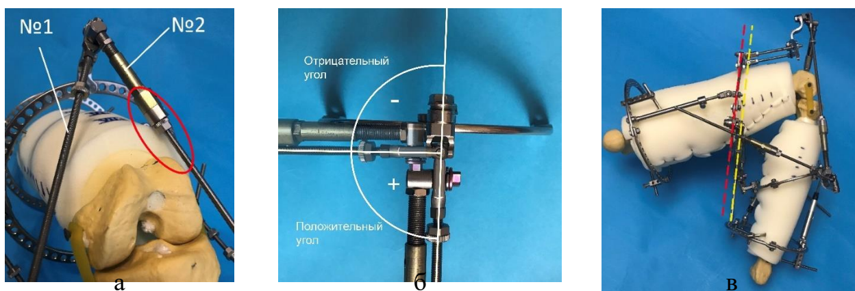
Рис. 3.2. Препятствия дальнейшему сгибанию: а - соприкосновение страты №2 с моделированными мягкими тканями; б – максимально возможное положение страты; в – страты №4 и №5 параллельны плоскости опоры (красная пунктирная линия положение опоры, желтая пунктирная линия положение страт №4 и №5)
