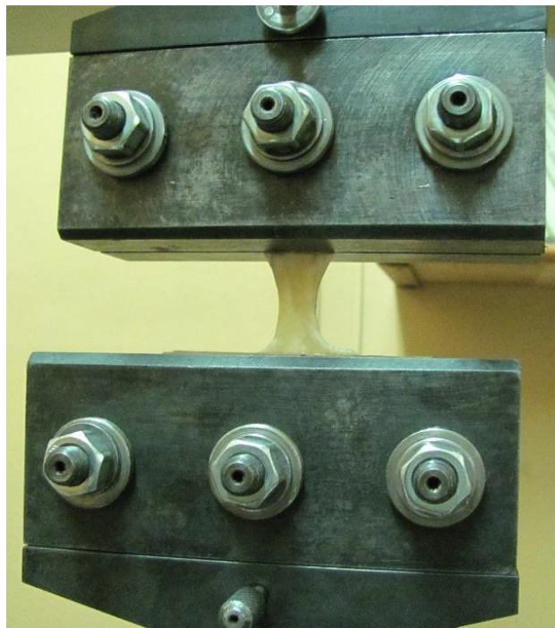
Рисунок 15. Аллосухожилие длинной малоберцовой мышцы, фиксированное в держателях разрывной машины
