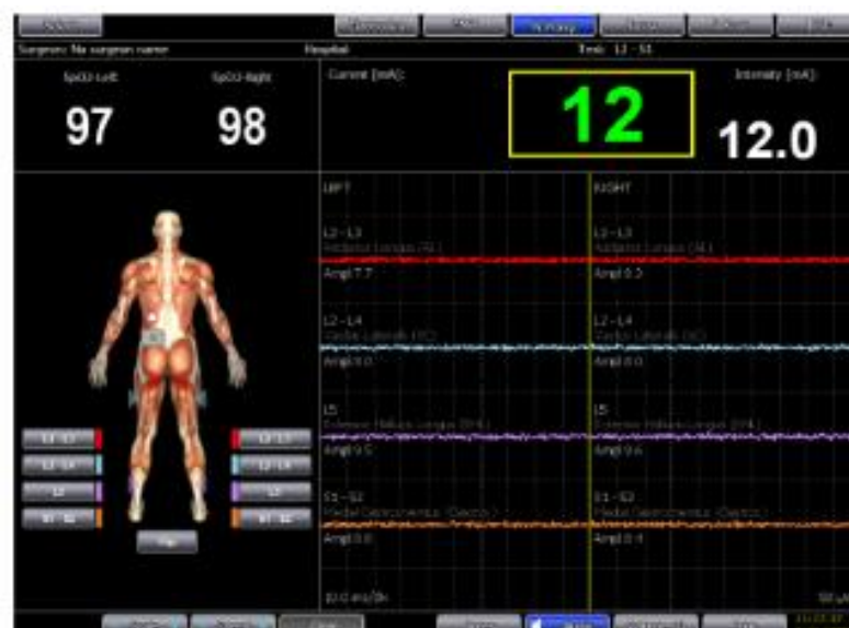
Рисунок 19. Регистрация изолинии при корректном формировании костного канала для транспедикулярного винта в теле позвонка.
