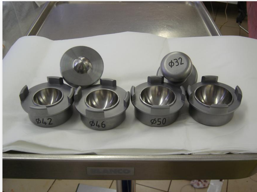
Рис. 9 – Формы для изготовления спейсера вертлужной впадины.
