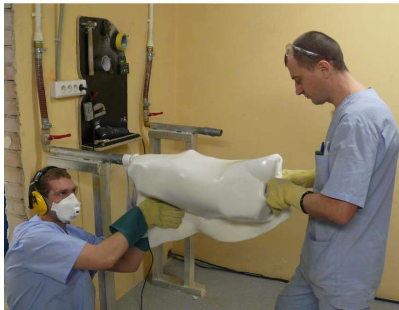
Рисунок 32. Блоковка полиэтиленовой гильзы корсета
