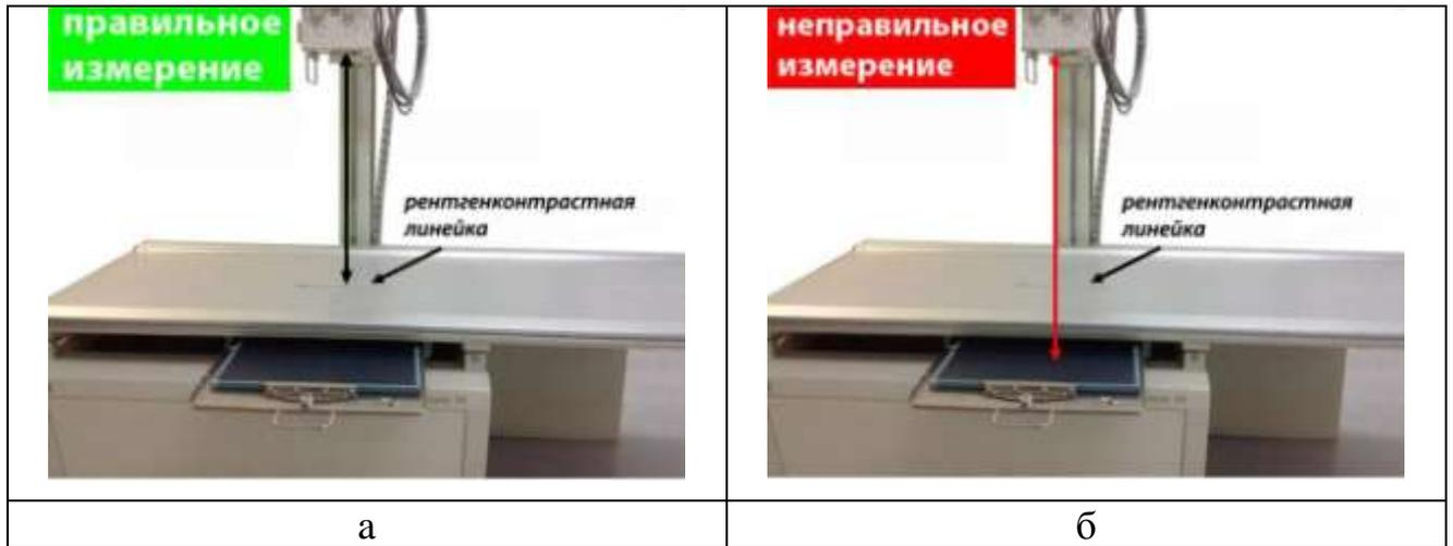
Рис. 4.11. Измерение фокусного расстояния при расположении кассеты в кассетоприемнике: а – правильное измерение; б – неправильное измерение
