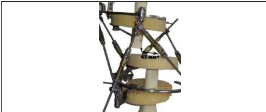
Рис. 2.12. Измерение величины поперечного перемещения
